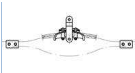
Sicherheitsschleife bei einer Hängekette
